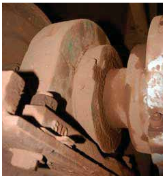
Abb. 20. Geteilte Zylinderrollenlager-Gehäuseeinheit von Timken in einer Anwendung in der Stahlindustrie
