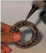
Befestigen von Lagern, Buchsen, Bolzen und sonstigen Füge­teilen im Schiebe- oder Presssitz.
